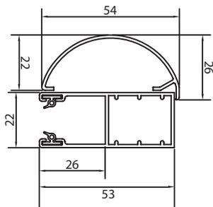
**Halbrunde Führungsschienen-Abdeckung passend für 53 mm breite Führungsschienen.**
